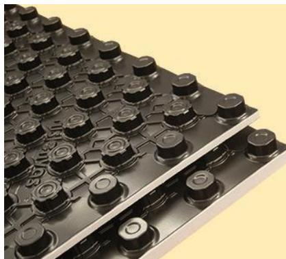
El acabado termoconformado es rígido e impermeable, lo que impide la pérdida de temperatura por vapor, aumentando además la resistencia mecánica del panel. Este se presenta moldeado y machihembrado a 4 caras mediante el plástico termoconformado, permitiendo una sencilla colocación de las placas y evitando puentes térmicos. La placa PLUS 32A de un paso de tubería de 50 mm, y es válido para tuberías de 16 y 17 mm. de diámetro.
