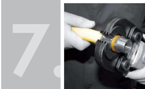
Расположите клещи, согласно диаметру трубы на гильзе из нержавеющей стали, как можно ближе к антиэлектролитному соединению.
