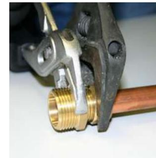
Наконец затяните гайку двумя английскими или фиксированными гаечными ключами, чтобы получить идеальное давление.
