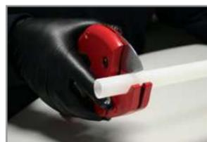
Отрезать трубу перпендикулярно ее длине, используя инструмент, который гарантирует чистый и точный срез.
