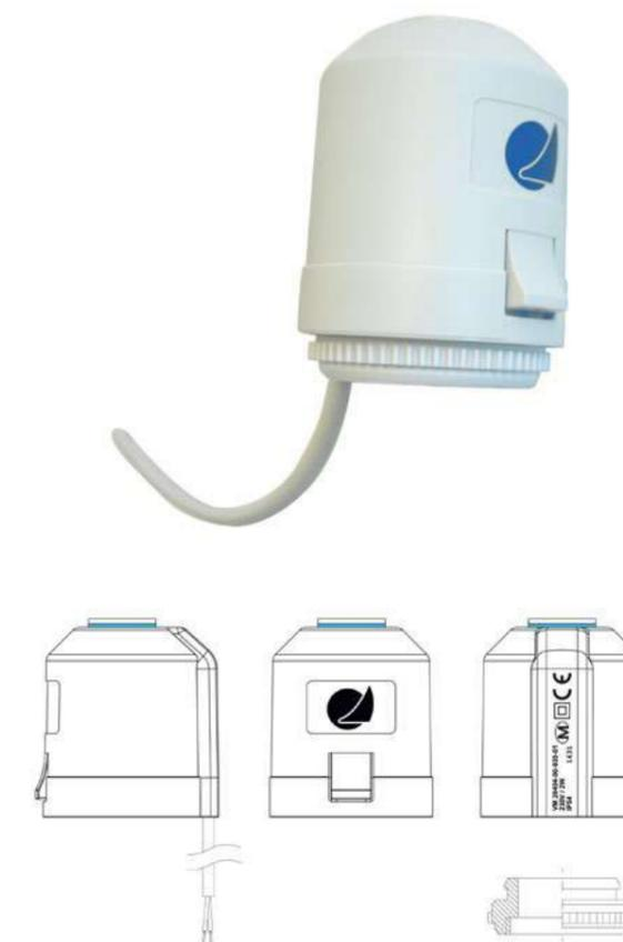
В основу работы электропривода положен принцип расширения жидкости при нагревании. Электрический ток, подаваемый на привод, проходит через греющий нихромовый проводник, который нагревает толуол, находящийся в сифонной герметичной емкости трубки.
