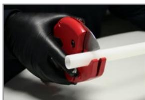
Отрезать трубу перпендикулярно ее длине, используя инструмент, который гарантирует чистый и точный срез.
