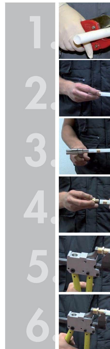
1. Разрежьте трубу перпендикулярно ее длине, используя инструмент, который гарантирует чистый и точный разрез.
