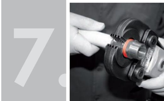
Расположите клещи, соответственно к размеру трубы, на стальную гильзу, как можно ближе к электролитному кольцу.
