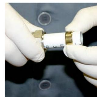
Размещение стопорного кольца на трубу.
