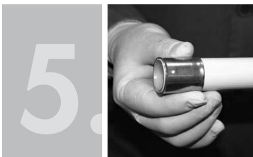
Вставьте стальную гильзу в трубу в том месте, где смотровое отверстие расположены на конце трубы.
