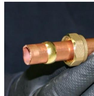
После того, как вставлена в трубу гайка вставить ниже стопорное кольцо.
