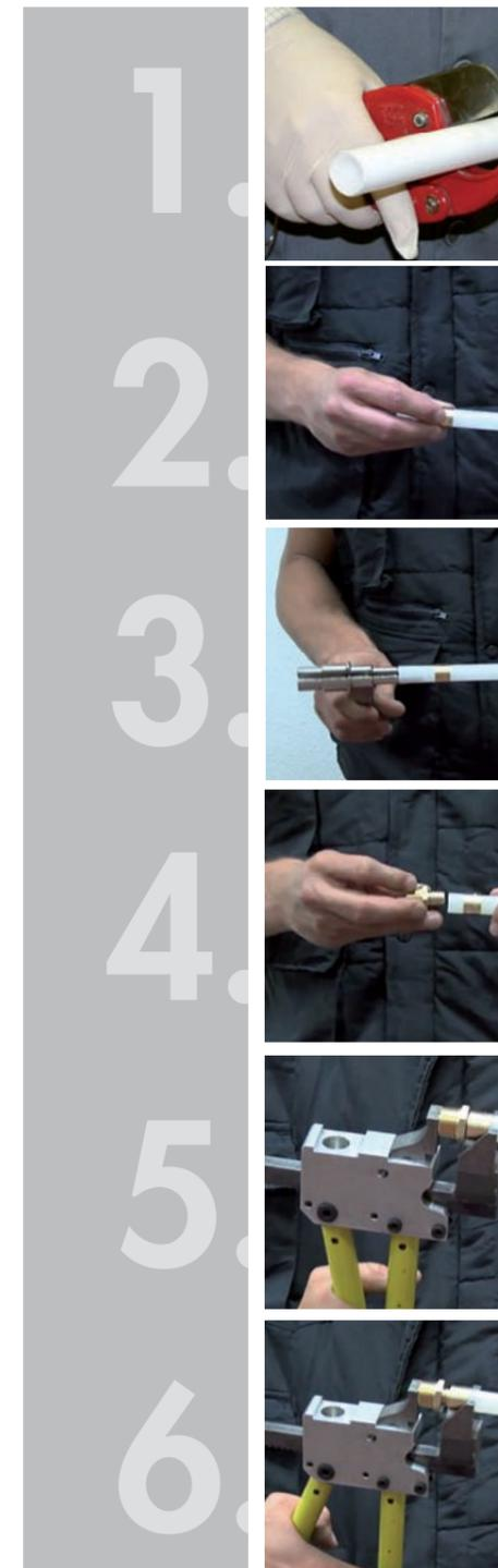
1. Cortar el tubo perpendicularmente a su longitud, utilizando para ello una herramienta que garantice un corte limpio y preciso.
