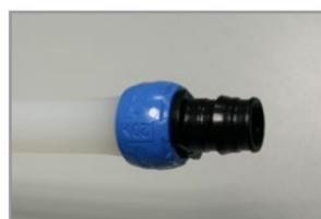
Sacar la herramienta e introducir sin demora el accesorio manteniendo la presión unos segundos hasta que la tubería se contraiga y sujete adecuadamente el accesorio.
