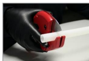
Cortar el tubo perpendicularmente a su longitud, utilizando para ello una herramienta que garantice un corte limpio y preciso.
