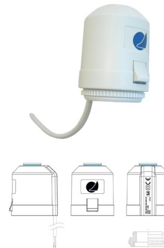
В основу работы электропривода положен принцип расширения жидкости при нагревании. Электрический ток, подаваемый на привод, проходит через греющий нихромовый проводник, который нагревает толуол, находящийся в сильфонной герметичной емкости трубки.
