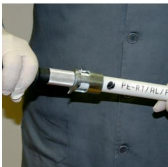
Il est obligatoire d'insérer le calibre/chanfreineur réf. AE à l'intérieur du tube, en tournant jusqu'à limer le bord intérieur et extérieur de celui-ci. Cette opération est essentielle pour faciliter l'insertion du raccord dans le tube et éviter que les joints toriques soient endommagés ou déplacés de leur logement.
