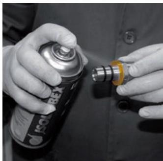
Lubrifier la partie du raccord à insérer. Lubrifiant ref. L-400
