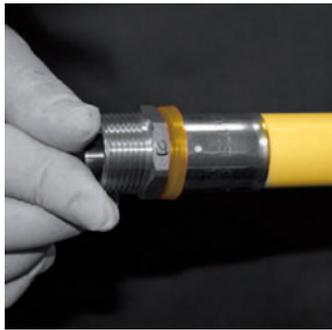
Le raccord doit être inséré dans le tube à sa base de sorte que la bague en inox soit fixé au joint en plastique anti-électrolyse.
