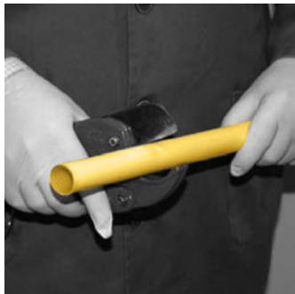
Couper le tuyau perpendiculairement à sa longueur, en utilisant un outil qui assure une coupure propre et précise.
