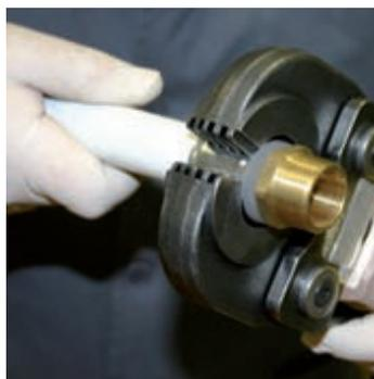
Positionner la pince de la mesure correspondante au tuyau, sur la bague 'inox, le plus près possible du joint d'électrolyse.
