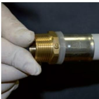
Il faut introduire l'accessoire dans le tuyau jusqu'à la base de façon à ce que la bague d'inox reste unie au joint plastique antiélectrolyse.
