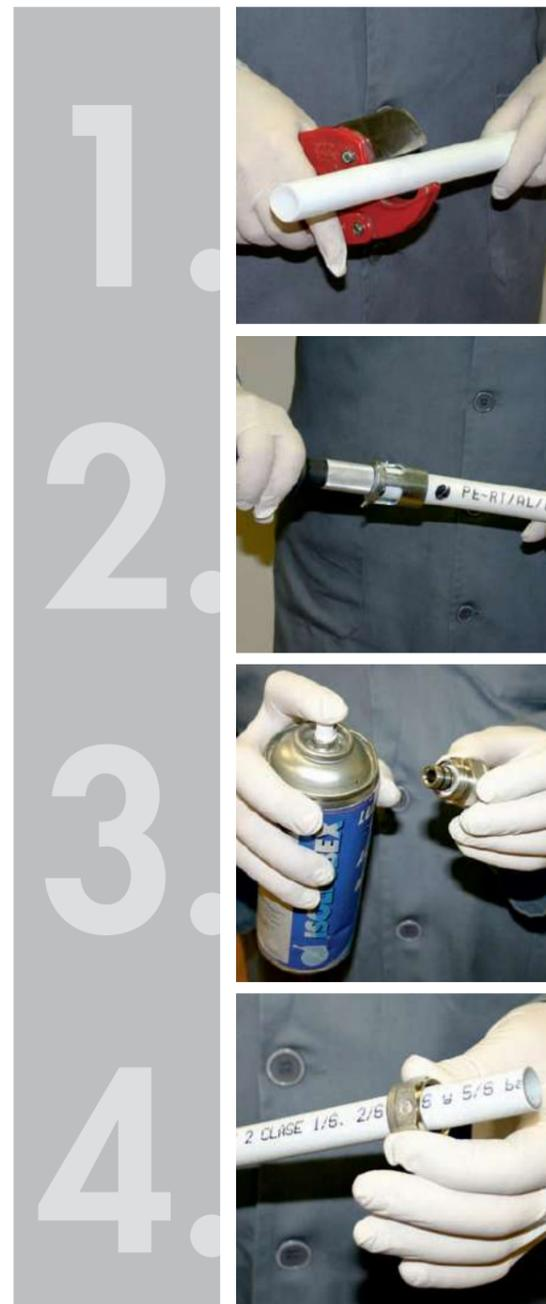
1. Cortar el tubo perpendicularmente a su longitud, utilizando para ello una herramienta que garantice un corte limpio y preciso.
